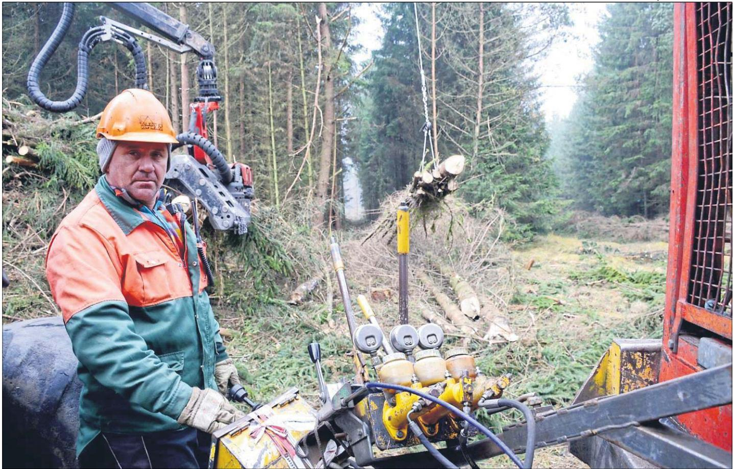
**Seilkrananlage im Einsatz:** Zum Schutz der Mooregebiete im Burgwald nimmt das Forstamt eine Fläche von 3,5 Hektar Nadelwald zurück. Weil auf dem nassen Boden keine schweren Maschinen fahren können, werden die gefällten Bäume mit einer Seilkrananlage an den Waldweg transportiert. Hier bedient Gabor Ioan von der Firma Hubert aus München die Anlage.
